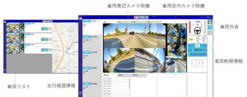
東海理化の遠隔監視システム
