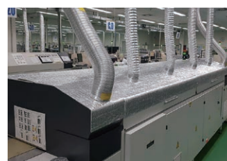
リフロー炉の断熱化
