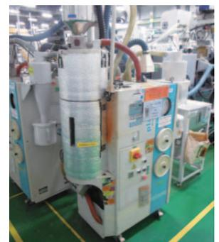
▲TRT (タイ) で実施した材料乾燥機の断熱施工
