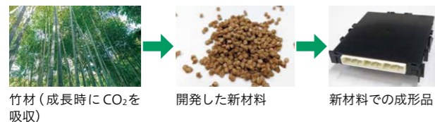
竹材(成長時にCO 2 を吸収) 開発した新材料 新材料での成形品
