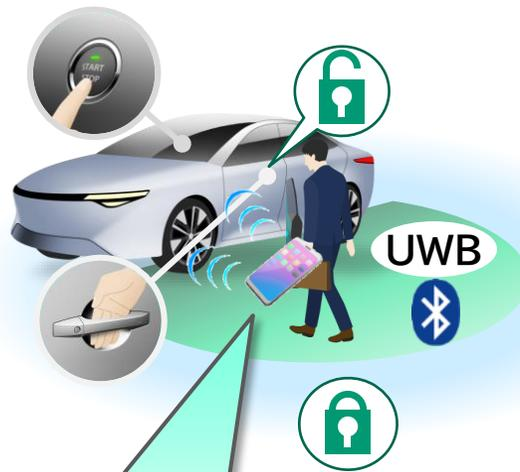
車両周囲でドアの施錠、車室内のみでエンジン始動
