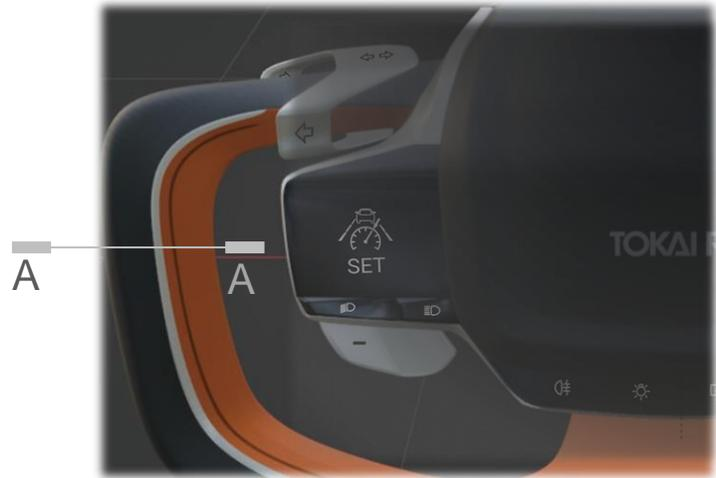
タッチセンサと照明を一体化、自動運転の状態表示と、手動運転引き継ぎ時に把持を要求、検知して通知
