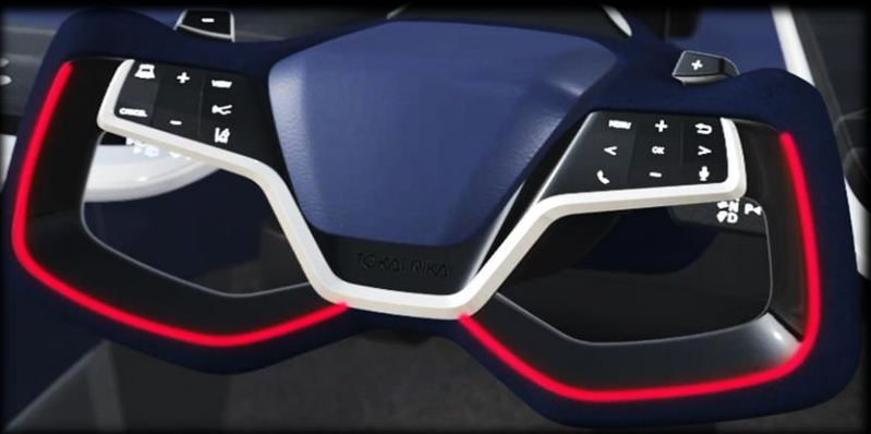
手動運転引き継ぎ通知と把持の検知（照明色：レッド）
