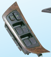
挟み込み防止機能付き パワーウィンドウスイッチ
