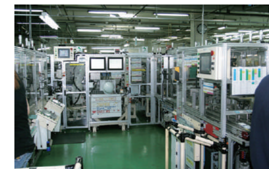
シートベルト自動組立ライン Automated assembly line for seatbelts
