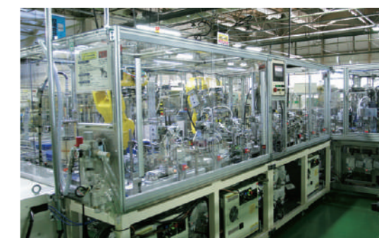
シフトレバー自動組立ライン Automated assembly line for shift lever
