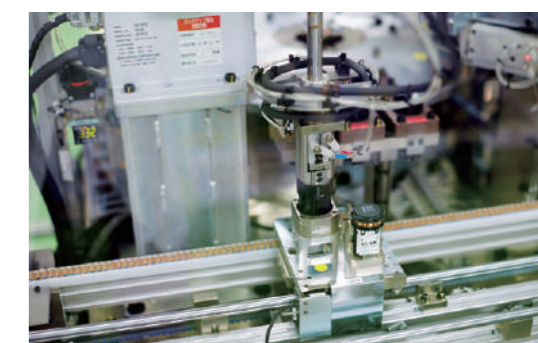
プッシュスタートスイッチ自動組立ライン Automated assembly line for push start switch
