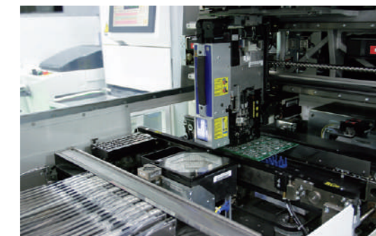
電子部品実装ライン(チップマウンター) An electronic component mounting line (chip mounter)
