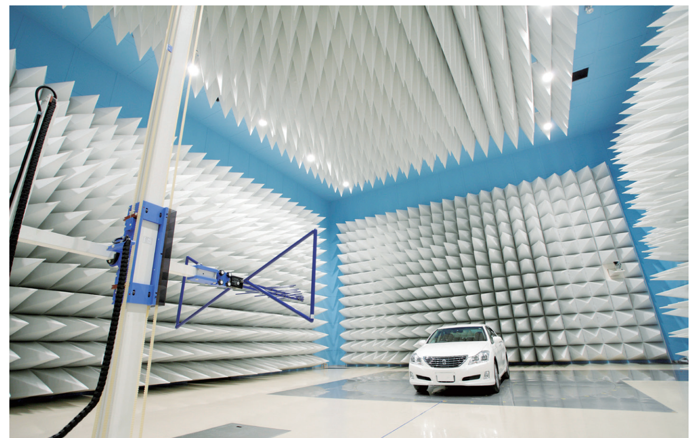
マイクロ波帯にも対応した、国内最大級の電波暗室 Japan's largest class anechoic chamber responds to microwave-band testing
