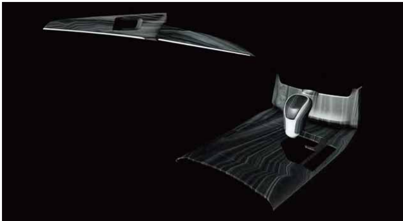
「3Dドライ転写」工法によって加飾された自動車用内装パネル
