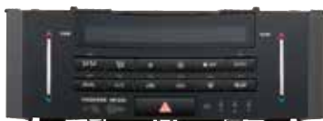
ヒーターコントロールスイッチ HEATER CONTROL SWITCH
