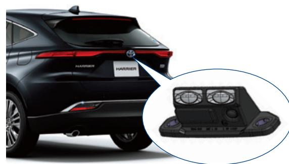
・ バックドアオープナースイッチ(ナンバープレートランプ一体)
