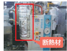
▲乾燥機断熱材設置
