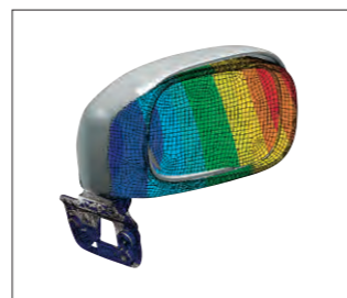
アウトターミラーの振動解析 Vibration analysis for a door mirror
