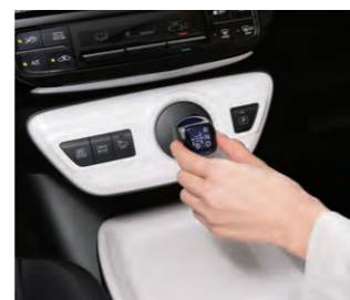
正確なシフトポジション判定が可能な磁気センサー技術 Magnetic sensor technology that enables accurate shift position determination
